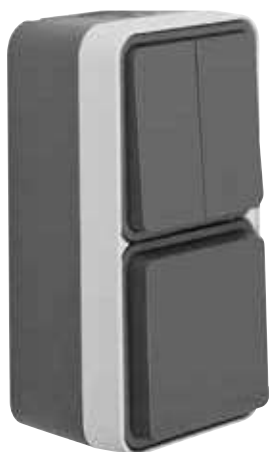
Kombination Serienschalter/Steckdose SCHUKO Ausschalter 2-polig mit Aufdruck zum Abschalten der Gartenklingel UAE-Steckdose 8-polig für den Datenanschluss
