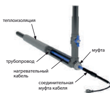
Установка внутри трубы
