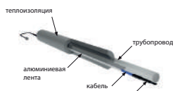
Установка на трубе
