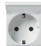
09208.C 16 А, немецкий стандарт, с крышкой - 2 модуля. Глубина: 29,5 мм
