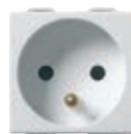
09212 16 А, французский стандарт - 2 модуля. Глубина: 26,4 мм
